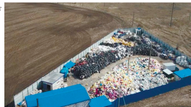
Последствия при несоответствии мощностей оборудования и объемов завезенных на площадку отходов
