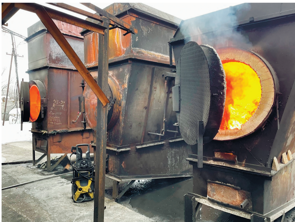
Нейтрализатор огневой НО Пиретта-500 создан для обезвреживания медицинских, ветеринарных, биологических и, других твердых и жидких отходов.
